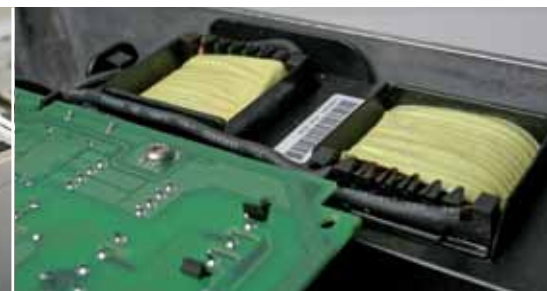
Las bobinas de CC integradas reducen el impacto en la red de alimentación y aumentan la vida útil del convertidor de frecuencia.
