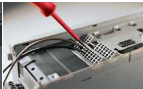
Las conexiones con resortes ahorran un tiempo y costes considerables, tanto en la reinstalación como en las tareas de servicio.
