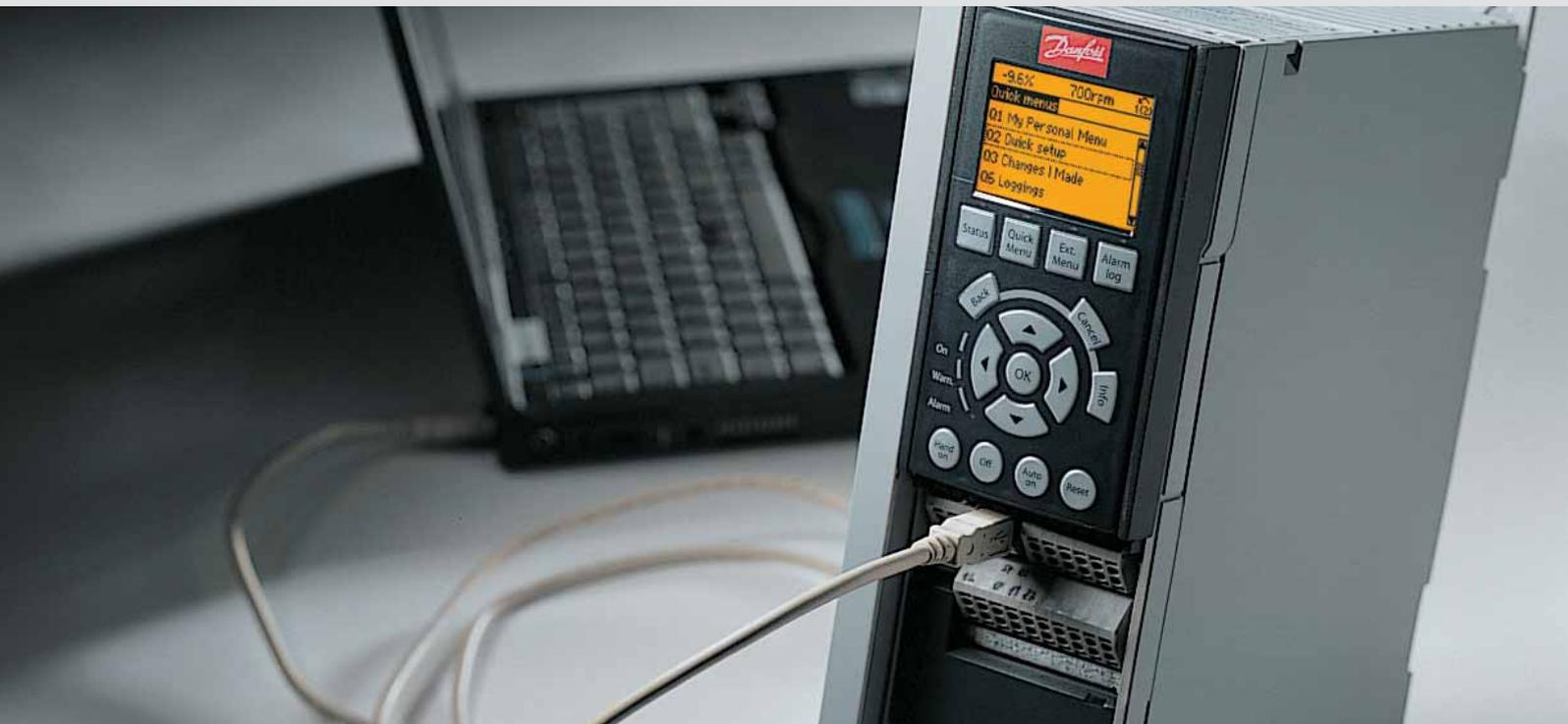
El software de configuración permite controlar fácilmente los detalles, así como una visión general de los convertidores de frecuencia, ya sean grandes o pequeños. Esta herramienta procesa todos los datos relacionados con los convertidores de frecuencia.
